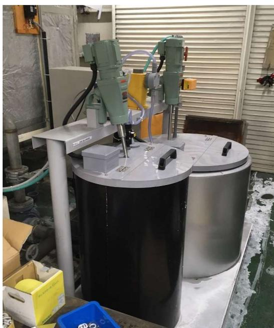
脱脂薬品補給装置
